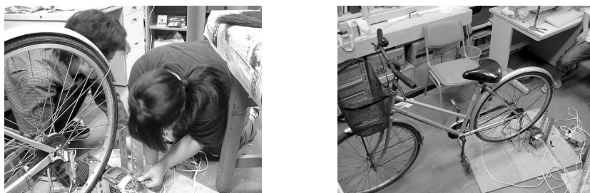
図2. (左) 自転車発電製作の様子、(右) 自転車発電1号機(平成14年当時のものである。その後、改良を重ね、よりシンプルかつ定量的考察ができる構造へと変わっている。)
